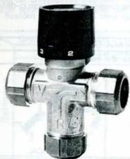
Le mitigeur d'eau sanitaire comporte une capsule thermostatique inversée. Son corps de bronze permet son montage sur des départs d'eau sanitaire en Ø 16, 18 et 22 mm. Le bouton de commande permet un réglage de l'eau sanitaire de + 38 °C à + 65 °C.
